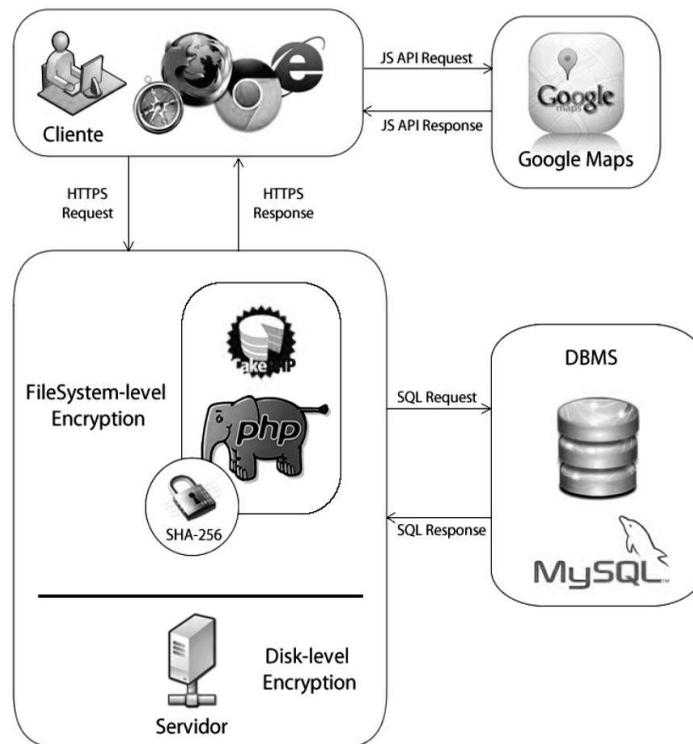
Figura 1. Vista arquitectónica de componentes y conectores del sistema GeoCan
